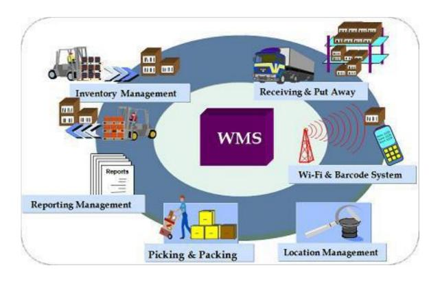
WMS-Tools unterstützen sowohl automatische Systeme und Lager (Material-zu-Mann) als auch die manuelle Verwendung (Mann-zu-Material). Im ersten Fall koordinieren sie automatische Transportgeräte, um die Ware automatisch zu bewegen, und im zweiten Fall führen und überwachen sie den Lagerarbeiter während der Arbeitsabläufe mit Hilfe mobiler Technik.
